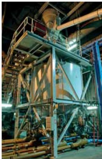
Tour de broyage : broyeur, trémie et pneumatiques (tuyaux jaunes)
