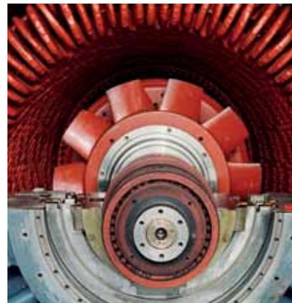
*Rotor et stator d'un alternateur*
