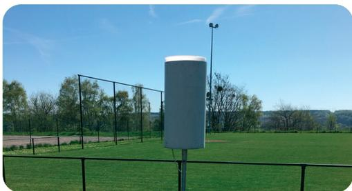
*Les poussières sédimentables sont mesurées à l'aide de jauges appelées « Owen ». Elles sont relevées tous les 28 jours. Il s'agit d'un système de mesure dit « passif » car il mesure la retombée de particules.*
