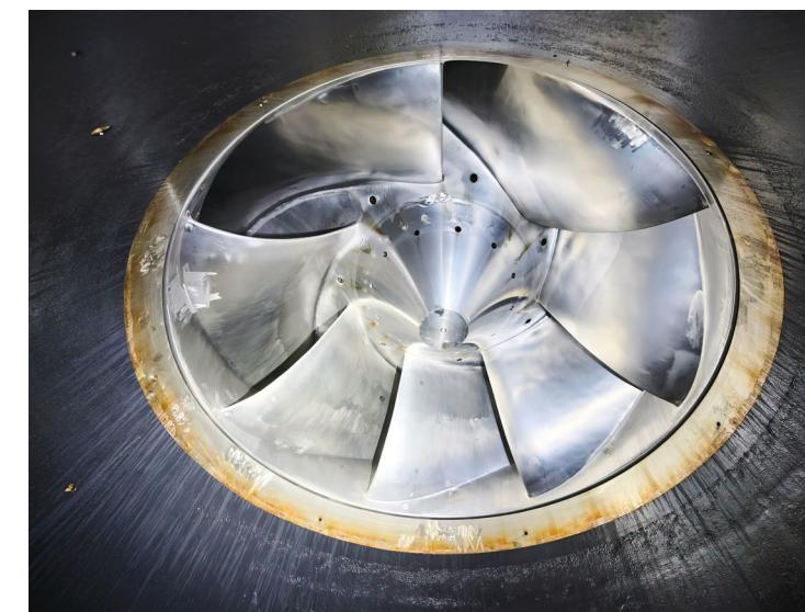
▲ Vue de la partie inférieure d'une roue de turbine
